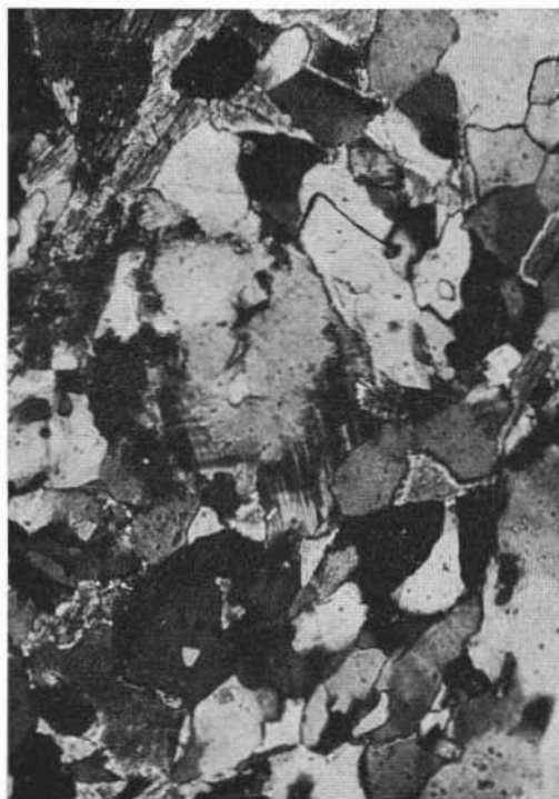
Fig. 13. — Gneis metablastico ad albite e microclino; Forcella Valzan- chetta, cristallino di Cima d'Asta. Un irregolare cristallo albitico è av- volto da un orlo di microclino. Nicols X, 116 ingr.
