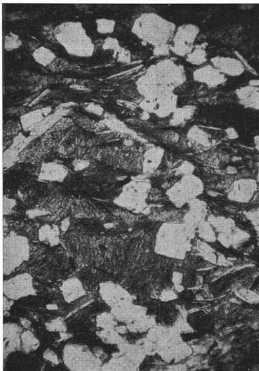
Fig. 3. — Epigneis a metablastesi albitica; Forcella Scanaìol, cristallino di Cima d'Asta. Subverticale è la prima scistosità, suborizzontale la seconda. I metablasti albitici sono quasi privi di inclusi e assumono forme idiomorfe. Irregolari lamelle di muscovite blastica accompagnano l'albite. 1 Nicols, 40 ingr.
