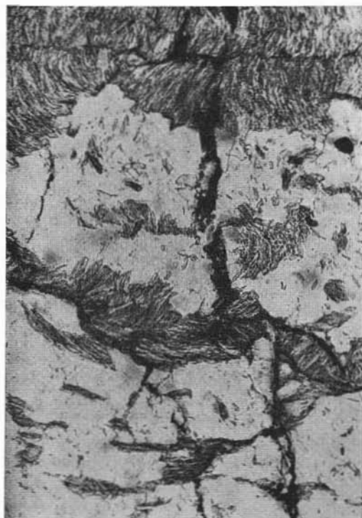
Fig. 12. — Quarzite micacea; California (Agordino). Si noti come nel quarzo siano mantenuti dei brandelli micacei con delicati motivi di ondulazione proseguenti l'ondulazione delle miche. Queste sono state corrose dalla crescita del quarzo. 1 Nicol, 116 ingr.
