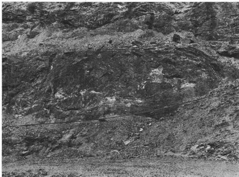
Fig. 6. — Nella zona mediana della foto si può osservare una lente di minerale, dalla caratteristica forma affusolata, nella quale appare con evidenza il fenomeno della laminazione periferica. Canaglia Est.
