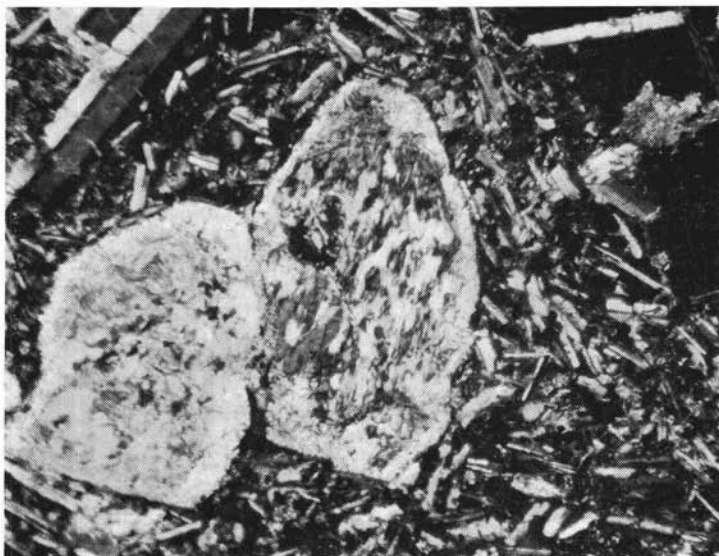
Fig. 3. — Aspetto strutturale in un campione prelevato alle salbande. Al centro della foto si notano due fenocristalli di probabile olivina completamente trasformata. (Nicols I; Ingr. 30 ×)
