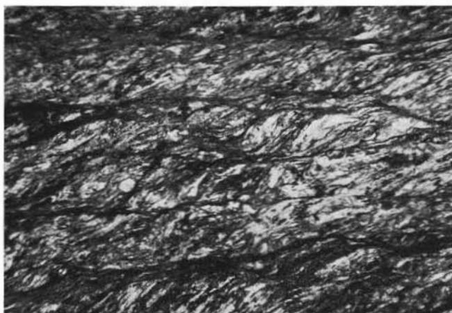
Fig. 8. — La scaglia tettonica di scisti cristallini della Zona Sesia-Lanzo nelle serpentine amiantifere di Balangero: micascisto milonitico ad attinoto, glaucofane, epidoto e granato, raccolto al gradino 774. L'originaria tessitura minutamente pieghettata  $S_1$  è in gran parte cancellata da un sistema  $S_2$  sub-orizzontale.
