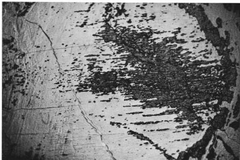
Fig. 2. — Pseudomorfo di granato (scuro), clorite e lizardite (chiaro) su pirosseno. Notare la disposizione del granato lungo le preesistenti tracce di sfaldatura. Solo polarizzatore - Ingr. lineare 35 \times .
