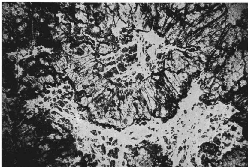
Fig. 7. — Plaga anulare di granato con al centro clorite (chiara) e granuletti di pirosseno relitto. Solo polarizzatore - Ingr. lineare 35 \times .
