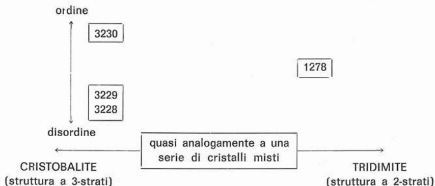
Fig. 11. — Schema di classificazione degli opali esaminati sulla base della composizione (fasi della silice presenti) e del relativo grado di ordine/disordine strutturale, determinati dai dati roentgenografici, IR e termici.
