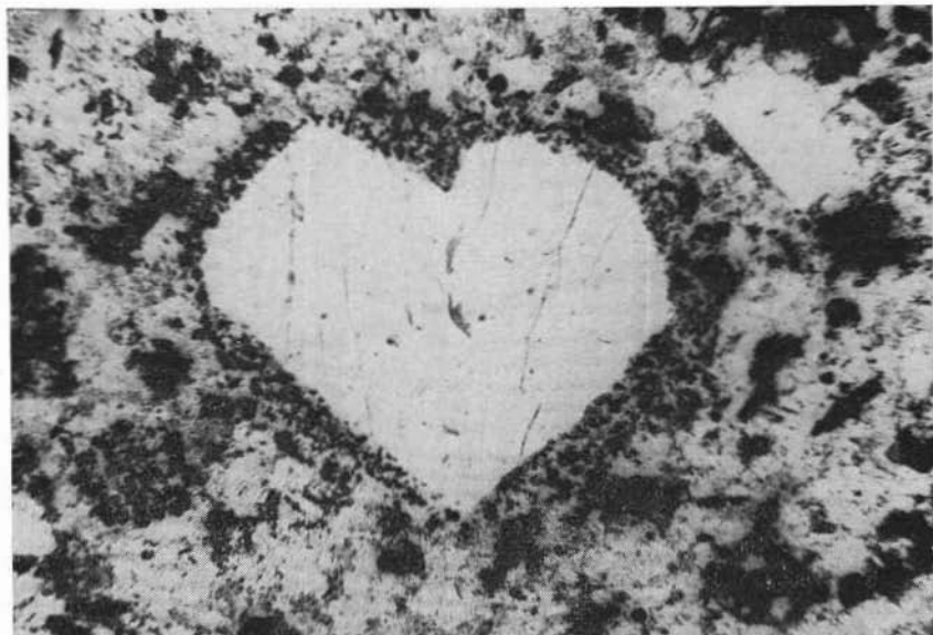
Fig. 1. — Sanidino. Carota prelevata nel pozzo Bagno dell'Acqua tra m 16,50 e m 17,85. Si osservi il fitto orlo di femici a grana minuta che lo circonda. Solo pol., 35 ingr.
