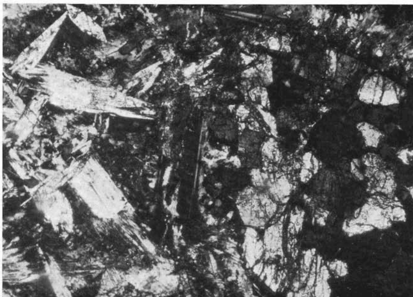
Fig. 6. — Al centro della microfotografia si riconosce un individuo idiomorfo di plagioclasio quasi del tutto albitizzato, compreso fra una vistosa plaga epidotica secondaria (a destra) ed un aggregato di cristalli anfibolici ad estremità molto sfrangiate che spiccano su un fondo albitico-cloritico.
