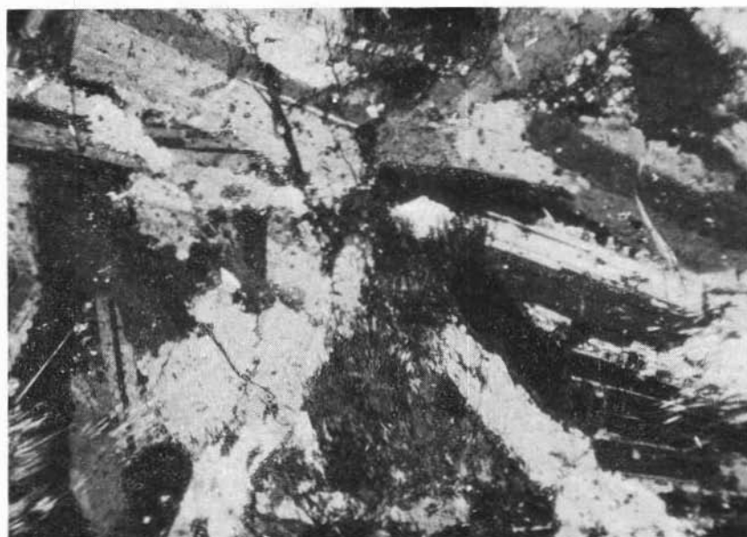
Fig. 4. — Esempio di struttura ofitica: vistosi individui idiomorfi di plagioclasio oligoclasico-andesinico, cristalli aciculari di orneblenda attinolitica chiaramente tardiva e plaghe di ilmenite con bordo di reazione costituito da titanite.
