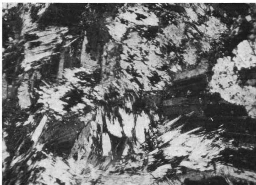
Fig. 2. — Cristalli deformati di orneblenda attinolitica, sfrangiati e parzialmente cloritizzati, attraversanti gli individui idiomorfi di plagioclasio.
