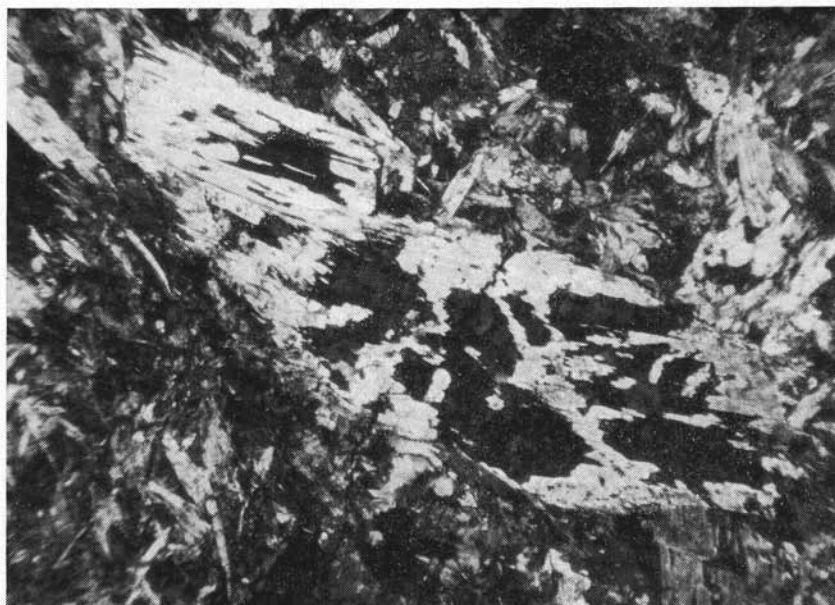
Fig. 5. — Cristalli anfibolici di dimensioni considerevoli cloritizzati in corrispondenza della parte nucleare o lungo i piani di sfaldatura o infine a chiazze irregolari. Metadiabase anfibolico (Monte Purritto). Nicol +; 53 \times .
