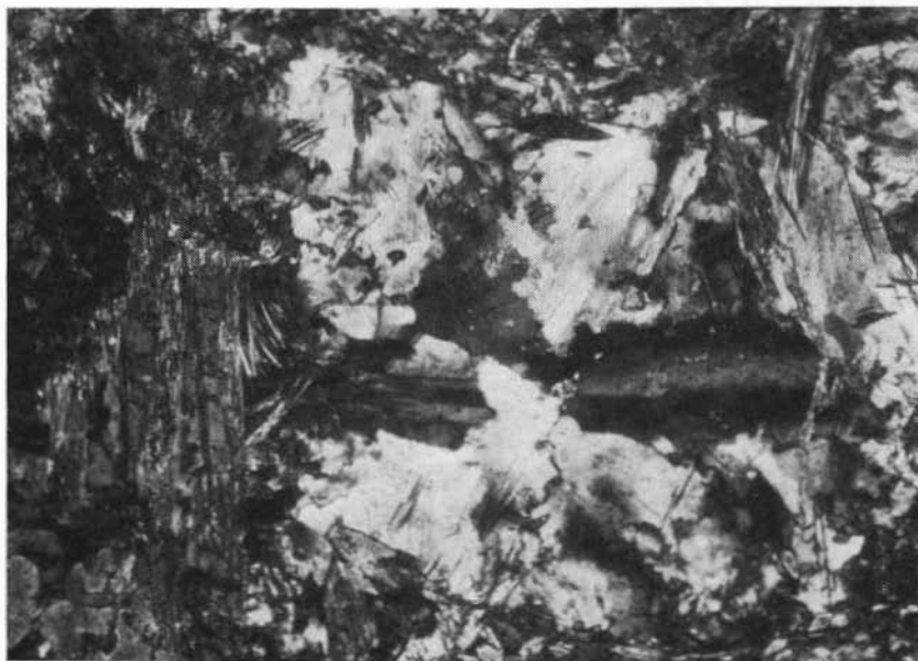
Fig. 3. — Residuo strutturale ofitico parzialmente intaccato, caratterizzato dalla associazione di individui plagioclasici quasi completamente albitizzati.
