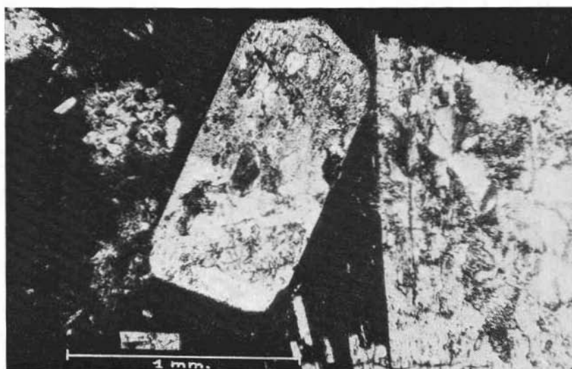
Fig. 17. — Fenocristalli di plagioclasio nel filoncello diabasico, sostituiti da albite con abbondanti inclusioni di pumpellyite e prehnite. A sinistra aggregato di clorite ed attinolute probabilmente pseudomorfo su orneblenda. (Nicol +; 45 ×)
