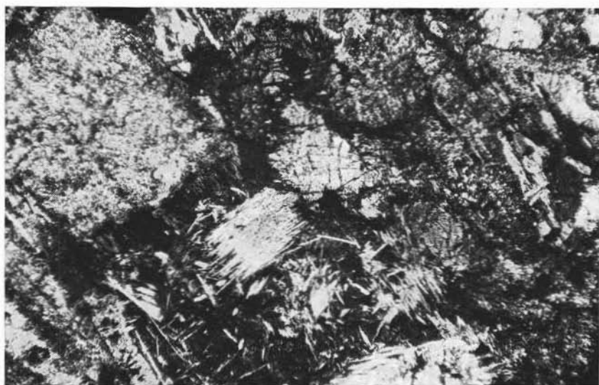
Fig. 2. — Relitti di pirosseno ed orneblenda parzialmente trasformati. Il pirosseno appare grigio ad alto rilievo. I minerali magmatici sono circondati da un aggregato di clorite ed attinolute di neoformazione. I plagioclasidi sono trasformati in sericite con poca albite (in alto a sinistra). (Nicol +; 35 ×)
