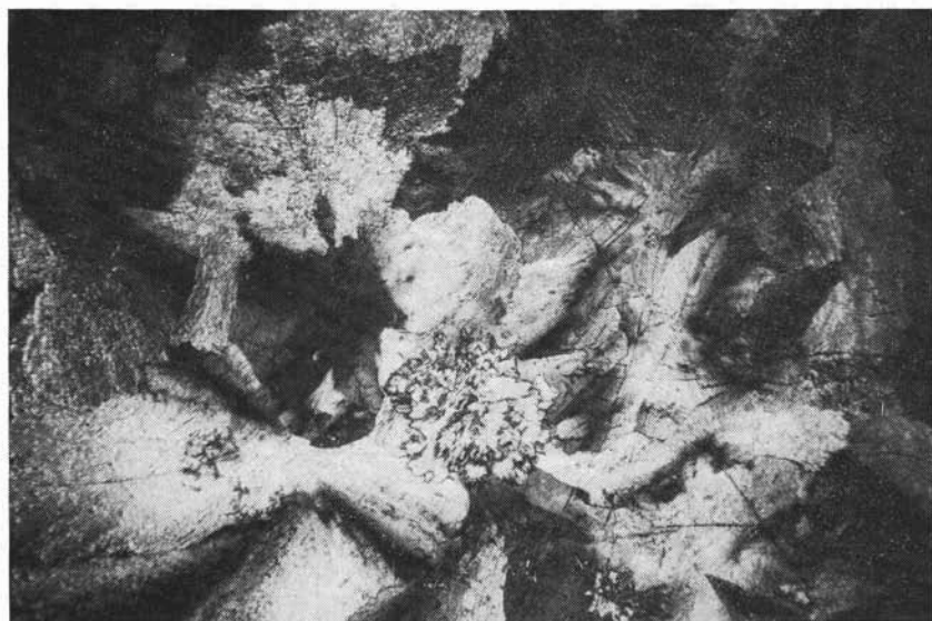
Fig. 12. — Area a prehnite. Aggregato a rosetta di pumpellyite (al centro) nella prehnite. (Nicol +; 125 ×)
