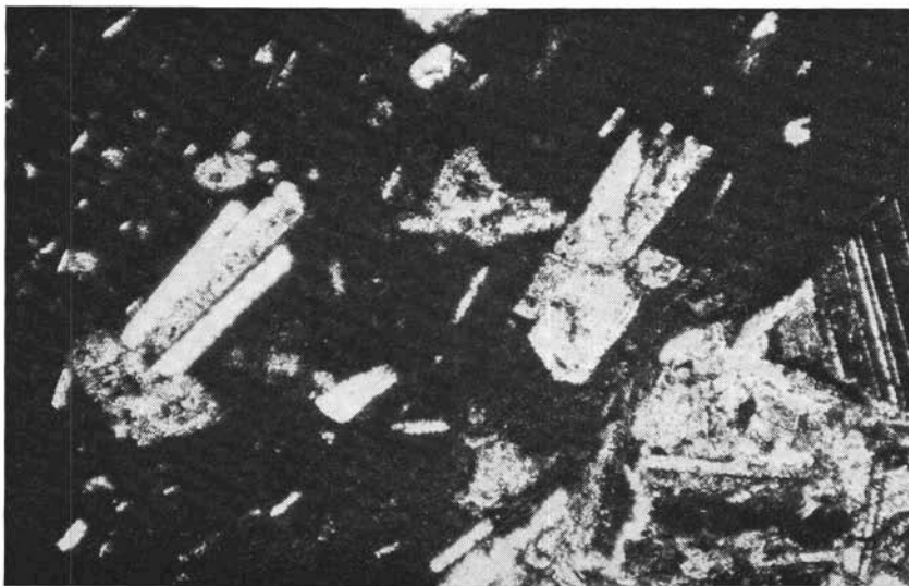
Fig. 16. — Contatto tra filoncello diabasico e diabase porfirico (in basso a destra). Microliti plagioclasici isoorientati (molto chiari) e piccoli aggregati di clorite con attinolite (grigi). La pasta di fondo è costituita da un finissimo aggregato semiopaco di albite, pumpellyite, titanite e minerale opaco. (Nicol +; 50 ×)
