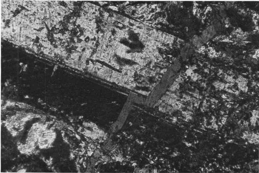
Fig. 3. — Grande individuo di plagioclasio sostituito da albite con inclusioni prismatiche di pumpellyite a rilievo molto alto e piccole plaghe di prehnite di forma irregolare. Anche la microfrattura che taglia il plagioclasio è occupata da albite. (Nicol +; 50 ×)
