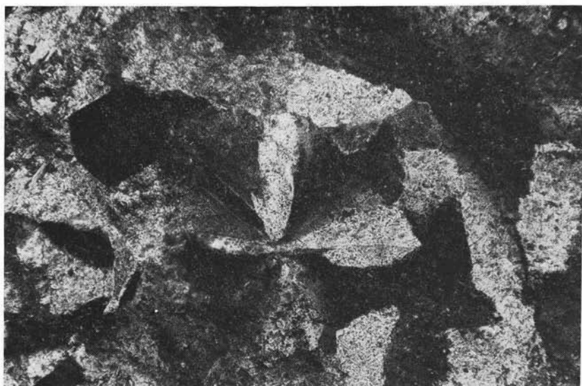
Fig. 11. — Area a prehnite. Aggregati di prehnite zeppi di finissime inclusioni costituiscono la quasi totalità della pasta di fondo, cancellando la struttura magmatica primaria. E' ben visibile un cristallo euedrale di picotite. (Nicol +; 50 ×)
