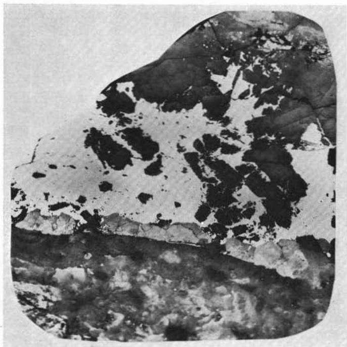
Fig. 3. — Mineralizzazione (tipo 5) di Breccia (Villaputzu): vena simmetrica con Scheelite (liste di color grigio chiaro), Antimonite centrale (bianco grigio), in roccia incassante (grigio). Grigio scuro: Calcite.
