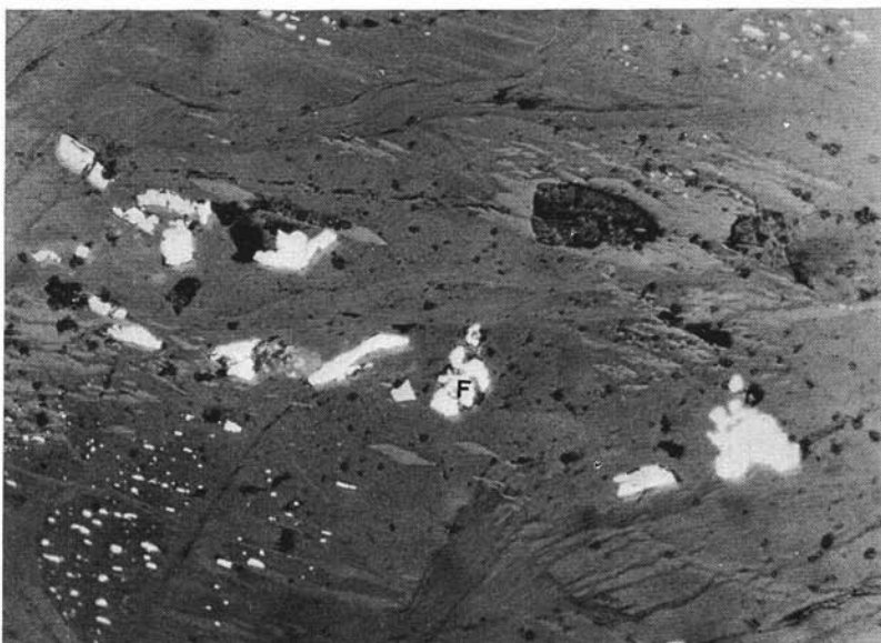
Fig. 6. — Microfotografia di sezione lucida di serpentinite dei dintorni di Rocchetta Vara. Gli individui bianchi sono di heazlewoodite; quello indicato con F è ferro-nichel nativo (solo polarizzatore; ingr. lin. 240).
