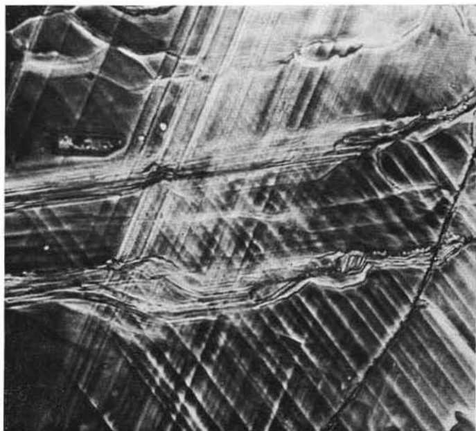
Fig. 3. — Due serie di bande di scorrimento parallele che si intersecano nella parte centrale con angoli di 60^\circ . L'esistenza di una sola serie di bande indica l'inomogeneità delle forze applicate. (Contrasto di fase: 100 \times ).
