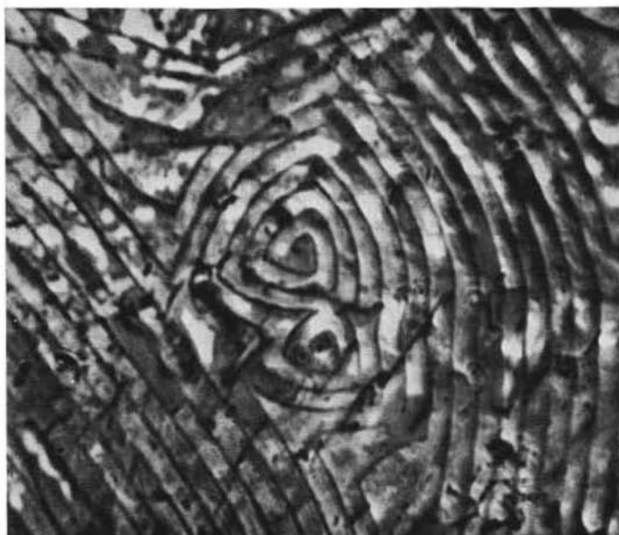
Fig. 12. — Interazione tra due spirali dello stesso segno con vettori di Burgers uguali. I fronti emessi dalle due spirali si incontrano formando parti concave che vengono prontamente riassorbite per rapido accrescimento. (Contrasto di fase; immersione in olio; 2600 \times ).
