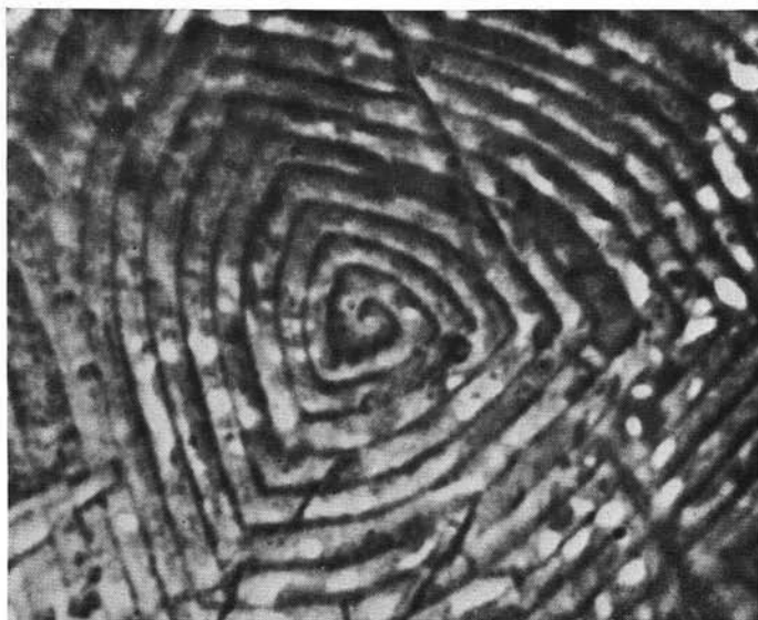
Fig. 11. — Spirale inizialmente a tre lati curvi che gradualmente poligonizza mantenendo sempre la simmetria ternaria. L'altezza dei gradini è dell'ordine della distanza d_{111} . (Contrasto di fase; immersione in olio; 2600 \times ).
