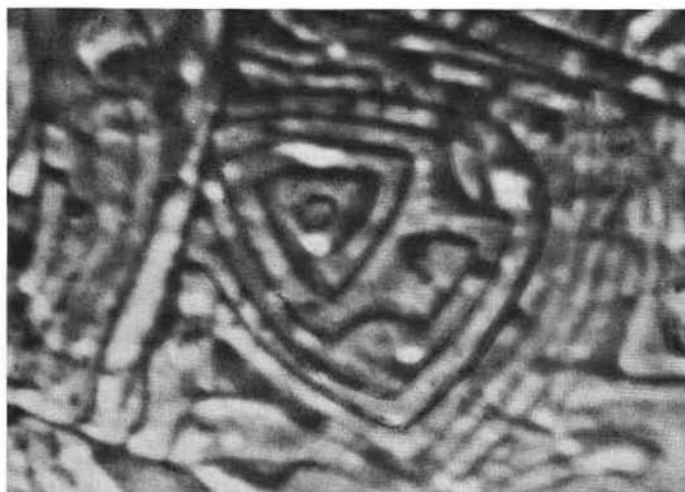
Fig. 13. -- Interazione di due spirali di segno opposto con uguali vettori di Burgers e formazione di una terrazza elicoidale. I fronti di crescita incontrandosi si annullano formando una unica terrazza piana che cresce successivamente per diffusione laterale come nella nucleazione bidimensionale. (Contrasto di fase; immersione in olio; 2600 \times ).
