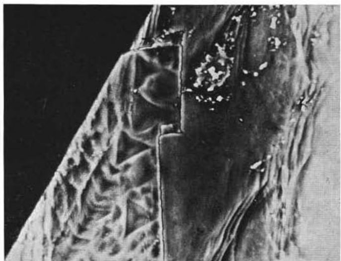
Fig. 7. — Porzione di faccia (111) costituita da domini distorti rivelati dalle figure di corrosione. Si noti l'andamento quasi parallelo tra la successione delle figure di corrosione e il lato [1\bar{1}0] della faccia (111). (Contrasto di fase; 100 \times ).
