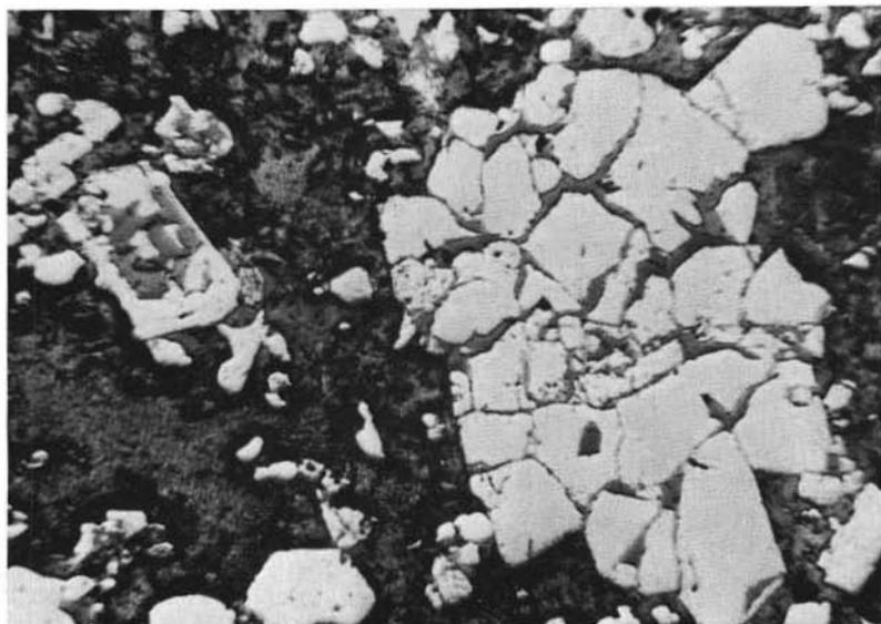
Fig. 13. — (ZL-1234, Nivel C). Magnetita detritica. Probeta pulida. 160 ×.
