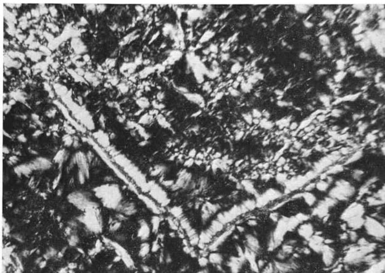
Fig. 4. — (ZL-1236, Nivel A). Biotita transformada en clorita (penninita-scheridanita). Nícoles cruzados. 380 ×.
