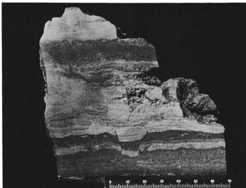
Fig. 12. — (ZL-1233, Nivel C). Alternancia de lechos de calizas y magnetita II.
