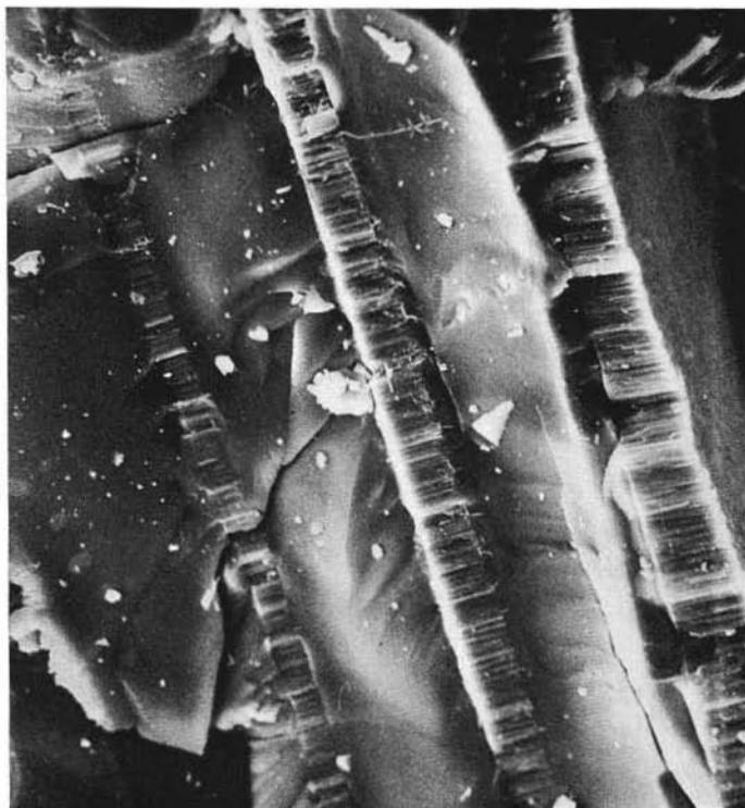
Fig. 6. — Fotografia al microscopio elettronico mostrandente l'epitassia fra levynite (strati compatti) ed erionite (strati fibrosi) di Nurri (ingr. 640).
