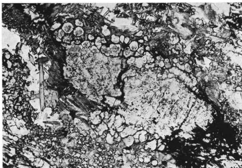
Fig. 1. — Facoidi di cloromelanite (Cpx-I), fratturato con una frangia di glaucofane nella sutura, circondato da una corona di cristallini di granato associati ad anfibolo barroisitico, passante esternamente ad una associazione actinolite + quarzo + epidoto. Solo polarizzatore; 25 ingr. lineari. (Camp. 69-GV-161).
