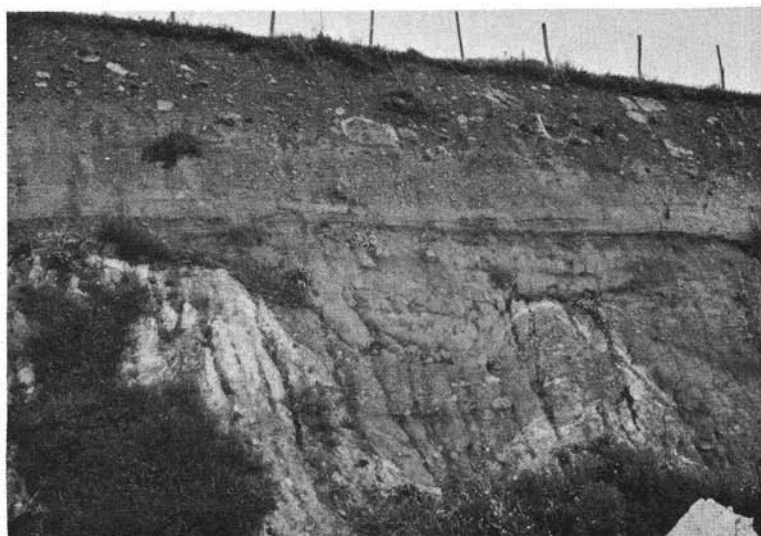
Fig. 8. — Giacimento di Pianciano-Castel Giuliano: la copertura ed il banco fluoritico sul fronte della coltivazione a cielo aperto; in basso a destra il banco sfuma in alcune fiamme inglobate nella ignimbrite sovrastante.
