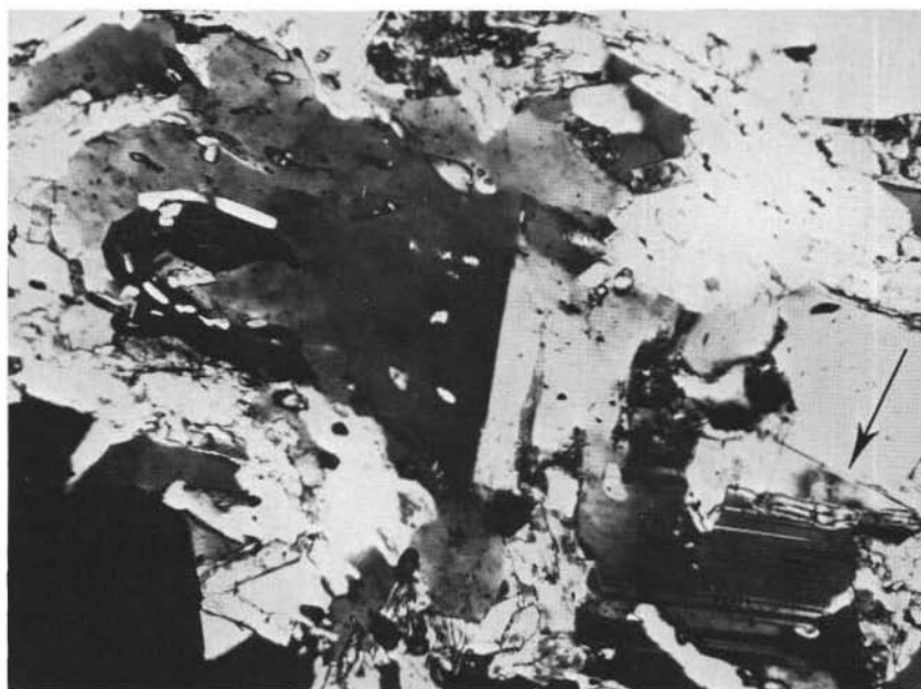
Fig. 8. — AA 46 - Micascisto quarzoso a mica chiara . Cristallo di plagioclasio a zonatura sfumata ed inversione delle estinzioni dal nucleo alla periferia. Attorno ad un nucleo sincinemico (An = 0-4 % - legge Periclino) si sviluppa, durante un successivo evento metamorfico, altro plagioclasio che nella parte più periferica raggiunge composizione andesinica (An = 37 %), geminando secondo la legge di Manebach. La freccia indica quest'ultima zona (Nicol incrociati; 165x).
