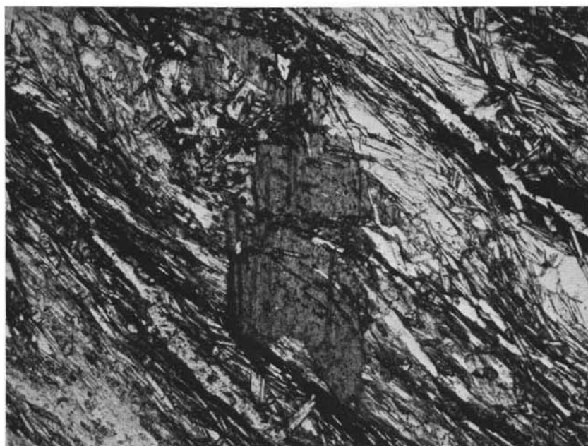
Fig. 5. — AA 464 - Micascisto a due miche . Blasto di biotite postcinematica in cui si osservano inclusi, prevalentemente epidotici, disposti secondo i piani di scistosità (solo polarizzatore; 38x).
