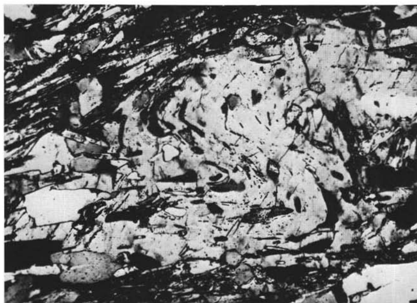
Fig. 9. — AA 404 - Micascisto quarzoso-feldspatico ad epidoto . Peciloblasto di plagioclasio postcinemico che fissa una micropiegia della roccia. Si osservino le tracce dei piani di sfaldatura del plagioclasio che tagliano in discordanza i piani di scistosità (Nicol incrociati; 103x).
