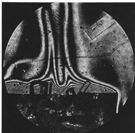
Fig. 2. — Crescita da soluzione di un cristallo di clorato di sodio in una vaschetta posta verticalmente. Vengono così evidenziati il gradiente di concentrazione in corrispondenza della faccia superiore del cristallo e i « camini » ascensionali dovuti alla convezione.
