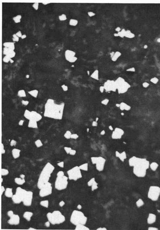
Fig. 2. — Cristalli cubici di pirite dispersi nel caolino (campione SF 125, sezione lucida, N //, X 110).
