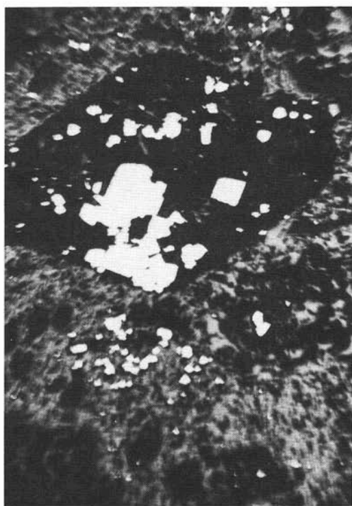
Fig. 3. — Cristalli di pirite concentrati all'interno dei fantasmi dei minerali femici (campione SF 215, sezione lucida, N //, X 40).
