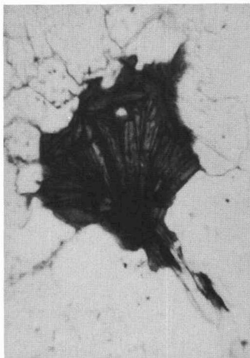
Fig. 11. — Nido di biotite di neoformazione a struttura raggiata (M. Unne), Nicols paralleli, ingr. lineari 180.
