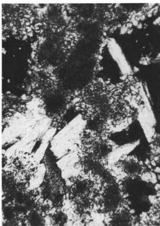
Fig. 4. — Cristalli di Celestina nel calcare brecciato e vacuolare. Sezione n. 4 (Grotte). Ingr. 130 X, Nicols +.
