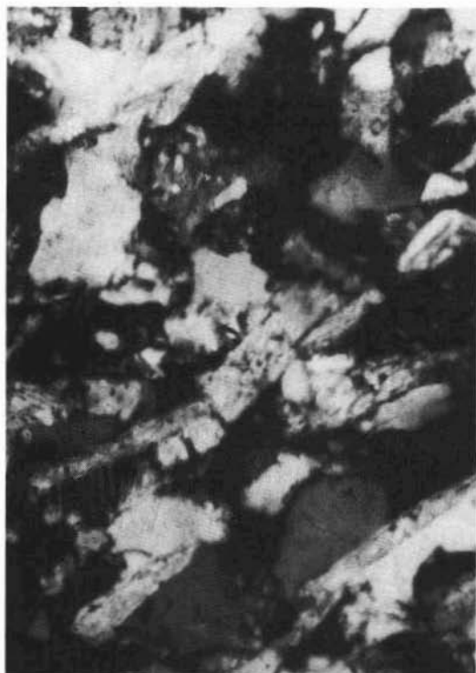
Fig. 3. — Arcosa di Serra del Zanchetto. Sono visibili cristalli di quarzo e feldspati a contorni seghettati e lamine di biotite isoorientate (in diagonale) - Nicols incrociati; 120 x.
