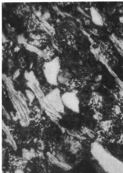
Fig. 4. — Arcosa trasformata di Serra del Zanchetto. Si osservano cristalli di quarzo, lamine isoorientate di biotite cloritizzata (in diagonale) e aggregati criptocristallini di clorite-saponite - Nicols incrociati; 240 x.
