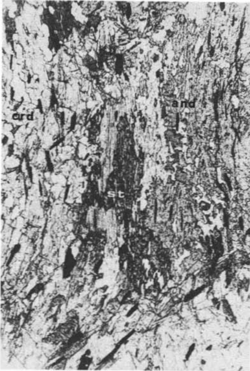
Fig. 11. — Micascisto a blastesi di andalusite: staurolite ( st ), andalusite ( and ) e cordierite ( crd ) di cristallizzazione statica. Solo pol., ingr. 25 X.
