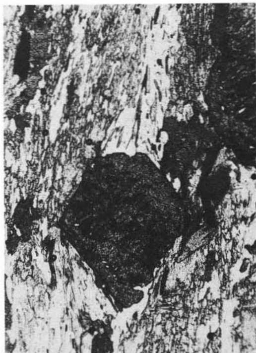
Fig. 10. — Micascisto a blastesi di andalusite: granato, andalusite e biotite statici. Solo pol., ingr. 25 X.
