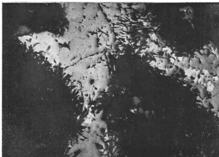
Fig. 3 — Valmaggia. Pentlandite (bianca), pirrotina (grigio chiara), magnetite (grigio scura), tra isole sfrangiate di silicati (quasi nere). 70 x
