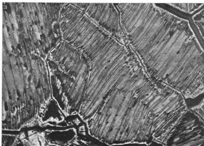
Fig. 4 — Menla. Marcasite tra le fratture e i piani di sfaldatura della pirrotina. A sinistra in basso un piccolo cristallo di bravoite. 130 x
