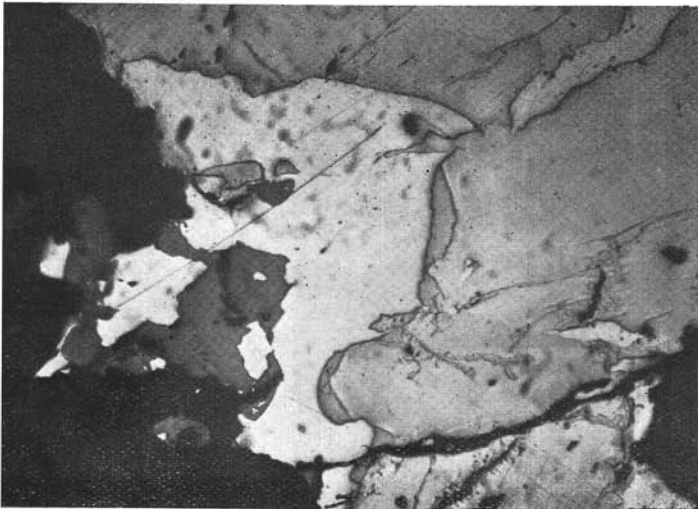
Fig. 6 — Val di Mengo. Calcopirite (grigio luminoso), blenda (grigio scuro), pirrotina (grigia con vene di marcasite); quasi neri i silicati. 70 x
