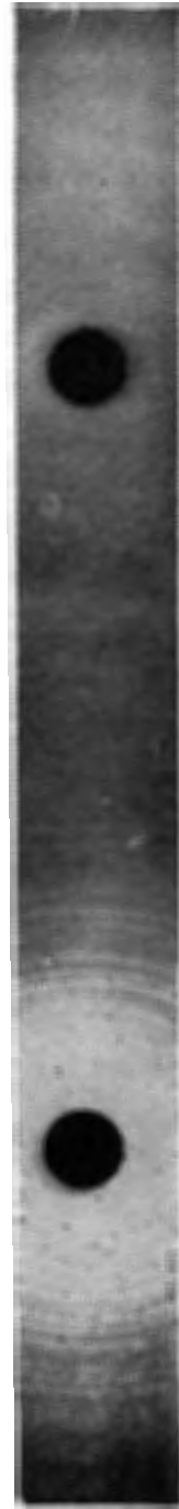
照片 2 莫氏刚玉石粉晶衍射图象
