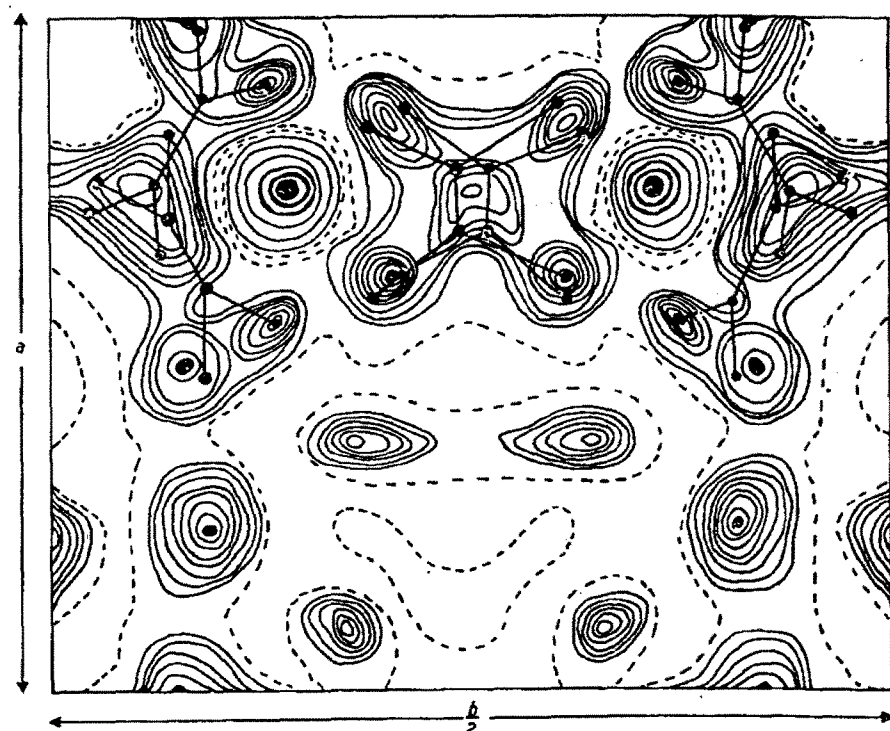
FIG. II-4. — Projection de Bragg du ferrotrioxalate sur le plan 001.
