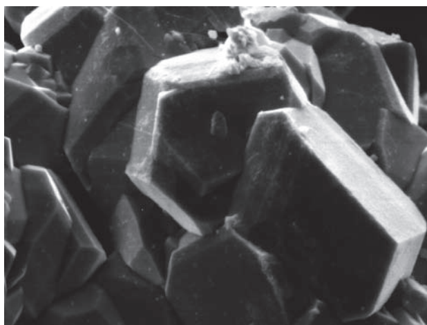
Fig. 205. J-716. Stromeyerite crystals in a cavity in chalcopyrite. Svornost shaft, Daniel level, Trojická or Geschieber vein. SE image. Magnification 1220 \times . Photo A. Gabašová.
