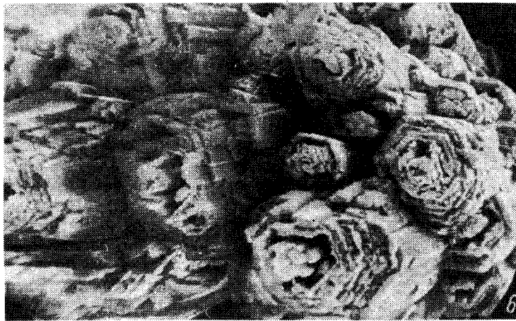
Рис. 2. Стрoение агрегатов карбонатов изоморфного ряда олекминскит—паральстонит. Фото на растровом электронном микроскопе BS-300.
