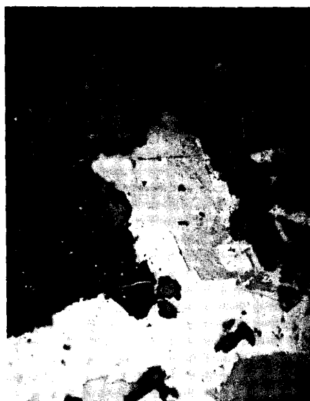
FIG. 2. — Agrégat zoné, xénomorphe, de krutaïte, tortement remplacé par la clausthalite. Même association que pour la figure 1. Section polie, lumière naturelle, immersion, \times 220 .
