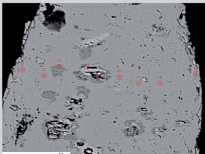
Imágenes SEM de la sección de un cristal pulido de čechita. En rojo, los puntos del análisis EPMA. Fotos: Xavier Llobet.
