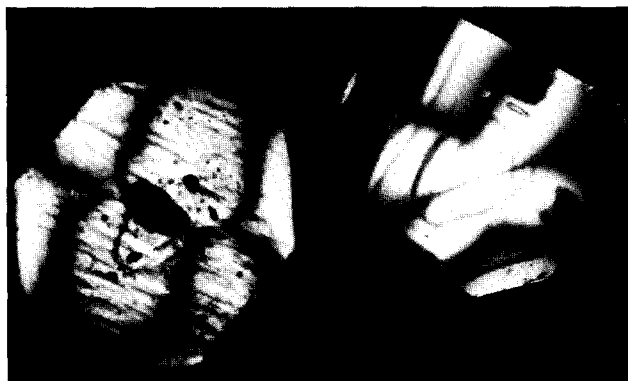
Fig. 2. Spannungsdoppelbrechung von Bariumnitratkristallen, 20\times
