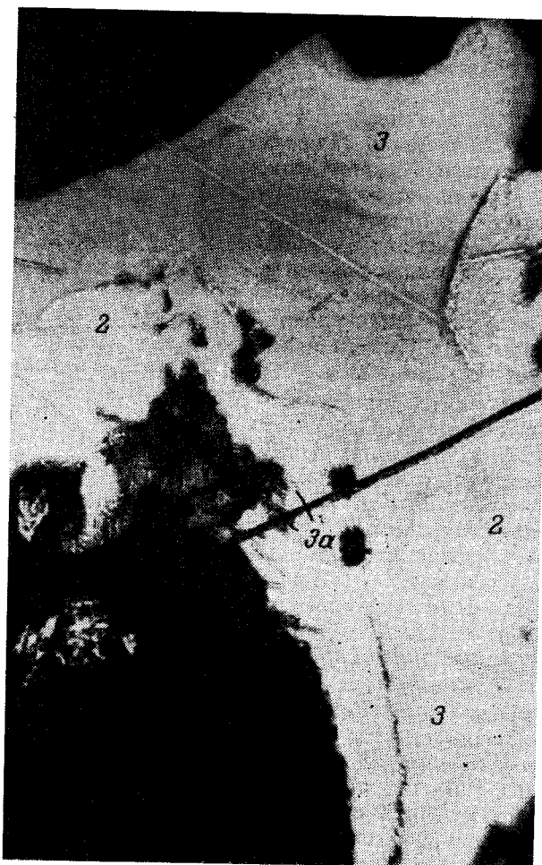
Рис. 1. Толовкит (1) в сростке с осмиридом (2) и иридомином I (3). Цементный полированный шлиф 26/22, запрессовано в стирокриле (черное). Увел. 108.
