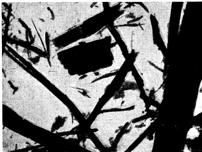
Рис. 2. Электронная микрофотография карбонат-цианотрихита. Обр. М-294, участок Баласаускандык. (Увел. 20 000).
