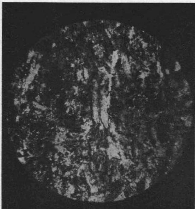
Fig. 4. — Id. c. s. Gesso saccharoide — Varietà giallo-rosata — Sezione tagliata normalmente al piano di sedimentazione. Esempio di struttura orientata. Microfotografia. 250 ingrandimenti Nicols incrociati.
