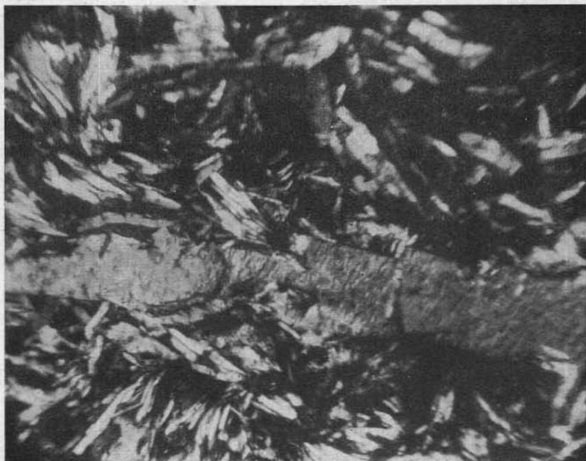
Fig. 1. — Associazione di cristalli di gesso, slittati l'uno rispetto all'altro, ciascuno di essi ospitante piccoli individui, pure gessosi, di neoformazione, disposti in allineamento subparallelo ai piani di scorrimento.
