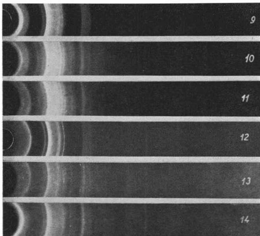
Fig. 16. — *Radiazione Cu K<sub>α</sub>*. *Diam. camera mm. 114,59.* (9), halloysite idrata; (10), tufo litoide, inferiore, Divino Amore, essiccato a temperatura ambiente; (11), come (10), ma essiccato a bagnomaria; (12), halloysite normale; (13), « cappellaccio » sulla pozzolanella di via di Cori, essiccato a bagnomaria; (14), come (13), ma essiccato a temperatura ambiente.
