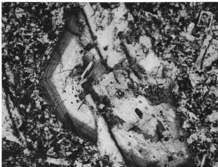
Fig. 4. — Latite della base nord-occidentale della Malgola con fenoeristallo plagioclasico fratturato, fittamente zonato e con nucleo anortitico . Ingr. 75 \times , Nicols +.
