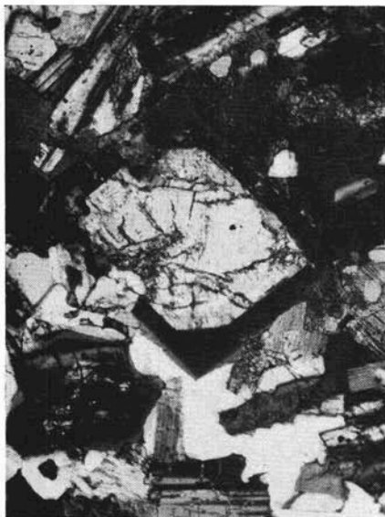
Fig. 1. — Monzonite a tendenza porfirica del versante settentrionale della Malgola. Al centro, individuo plagioclasico con nucleo molto calcico (quasi anortitico), fratturato e corrosivo. Ingr. 75 \times , Nicols +.
