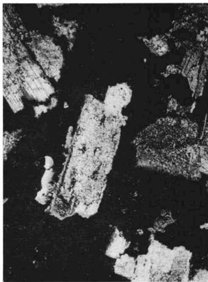
Fig. 2. — Monzonite della base nord-occidentale della Malgola, ad un metro di distanza dalla latite. Plagioclasii fortemente corrosi dall'ortoclasio (plaghe seure). Ingr. 75 \times , Nicols +.
