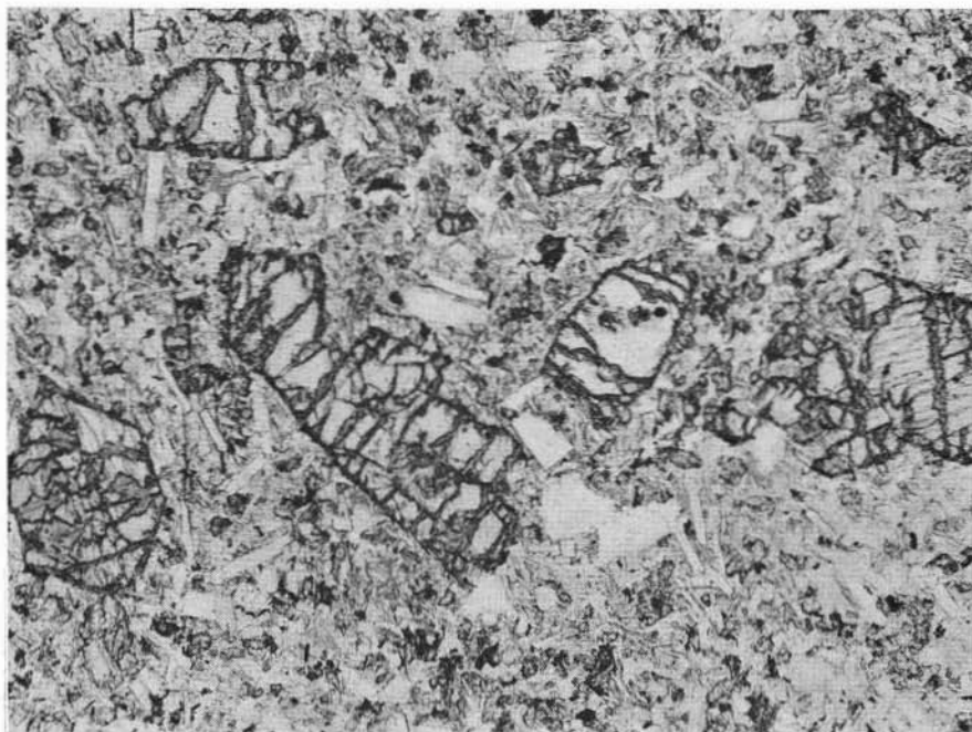
Fig. 1. — Fenocristalli di olivina alterati in bowlingite nel trachibasalto di base. Nicols paral. (30 \times ).
