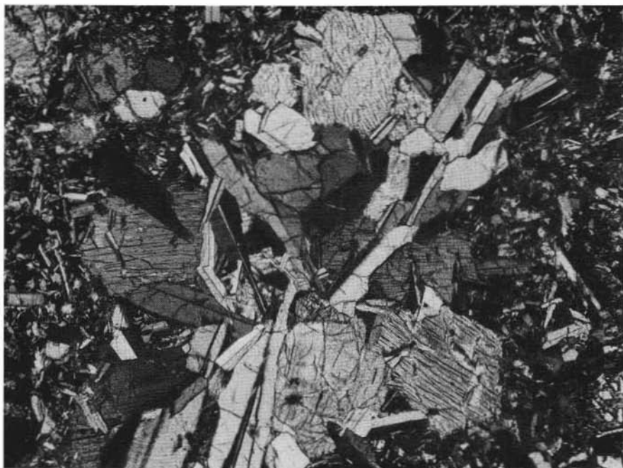
Fig. 2. — Struttura glomeroporfirica con nodulo di plagioclasti e di pirosseni nel trachibasalto di base. Nicols iner. (38 \times ).
