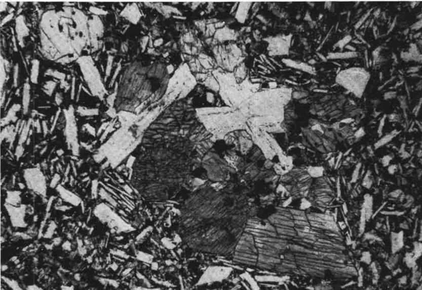
Fig. 20. — Etna (Montagnola) - Addensamento glomerofirico di cristalli prevalentemente feldici nella vulcanite MS_{30} . Nicols //; ingrand. 40 \times .
