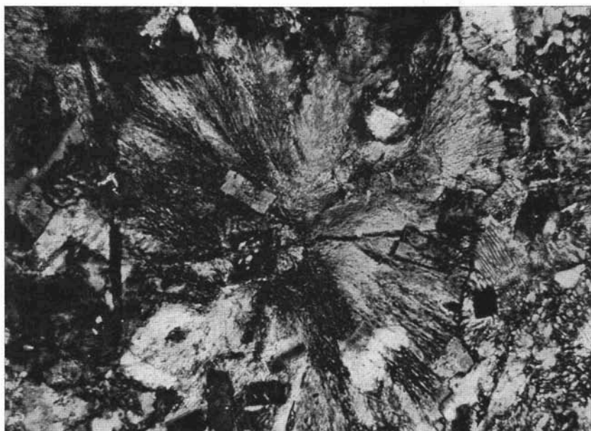
Fig. 5. — Granofiro (C.S.G. 105). Aggregati micrografici minuti ad accrescimento fibroso-raggiato. (Nicol +; 170 ×)
