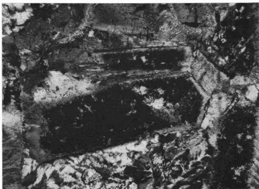
Fig. 7. — Porfido granodioritico (C.S.G. 51). Plagioclasti con nucleo opaco saussuritizzato e bordo limpido più alealino. E' evidente, alla periferia dell'individuo più sviluppato, l'associazione grafica. (Nicol +; 160 ×)
