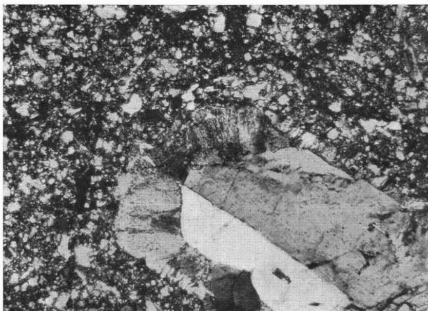
Fig. 4. — Porfido granitico (C.S.G. 38). Fenocrystallo di ortoclasio bordato da una frangia di aciculi di feldspato potassico e quarzo, dovuta a fenomeni di reazione fra il fenocrystallo e il fondo. (Nicol +; 60 ×)
