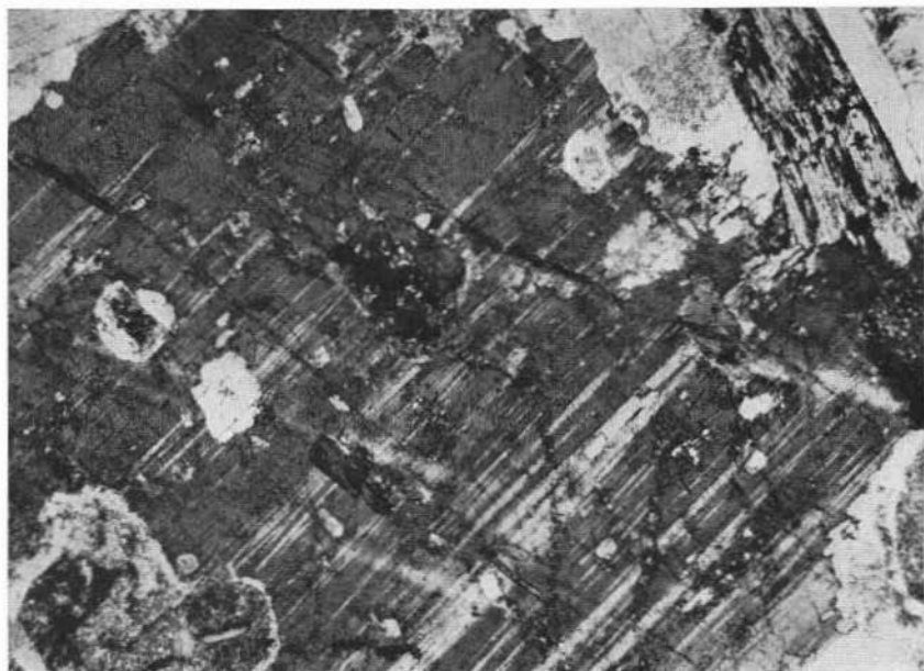
Fig. 7. — Granito a due miche ed a grandi cristalli di K-feldspato; Satriano (Cez III 96 a). Cristallo di microclino con inclusioni di biotite, quarzo e plagioclasti; questi ultimi presentano un nucleo alterato di composizione andesinica ed una parte periferica, più o meno sviluppata, limpida di composizione albitico-oligoelastica. Ingr. 30 \times .
