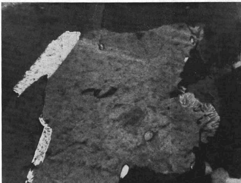
Fig. 8. — Ortogneiss di Antigorio (sez. SS.1/c) - Plagioclasio totalmente o quasi omogeneizzato: nella parte alta del cristallo si distinguono resti appena accennati di lamelle Albite. (nicols iner.; ingr. lin. 105)
