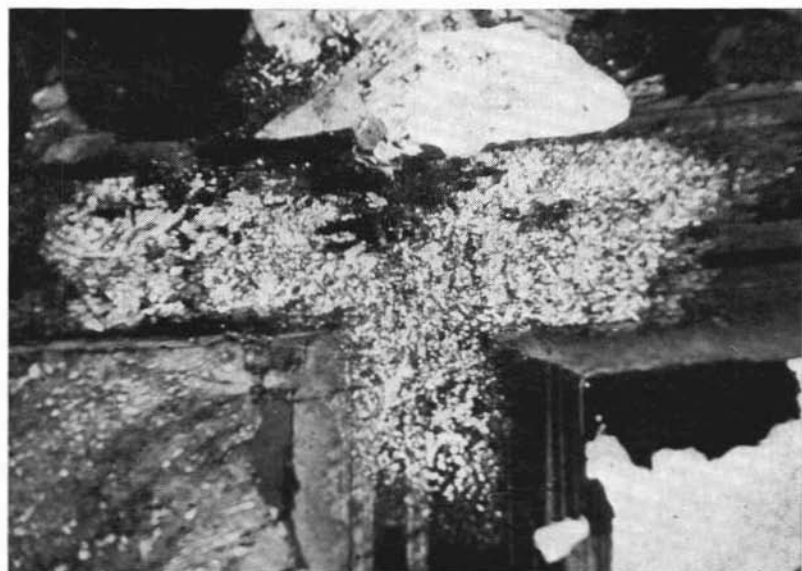
Fig. 1. — Granito del Biellese (sez. D. 8/1233) - Geminato primario Baveno di tipo Banato, forma a «T»; si noti anche la caratteristica alterazione pseudomorfica sericitica. (nicols iner.; ingr. lin. 35)
