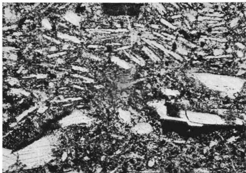
Fig. 6. — Sono evidenti il diopside, la flogopite e la melilite. In questo campione la melilite è più sviluppata che altrove e presenta una certa isoorientazione. La zona nera, a destra, vicina alla flogopite, è costituita dai prodotti di trasformazione della mica. (solo polar.; ingr. lin. 30)
