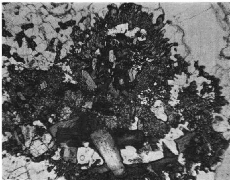
Fig. 8. — Incluso endometamorfico . Addensamenti di lamine di mica circondati da una « corona » di pirosseni. (nicols iner.; ingr. lin. 35)
