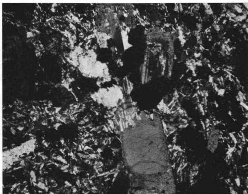
Fig. 7. — Incluso endometamorfico . Il sanidino «corrode» e borda il plagioclasio. (nicols iner.; ingr. lin. 25)
