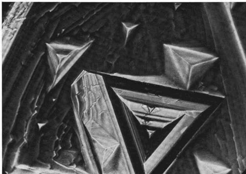
Fig. 3. — Veduta generale d'insieme, di cui la fig. 2 è un particolare. La corrosione ha generato un grande foro a contorno pseudoesagonale. Contrasto di fase. 335\times .
