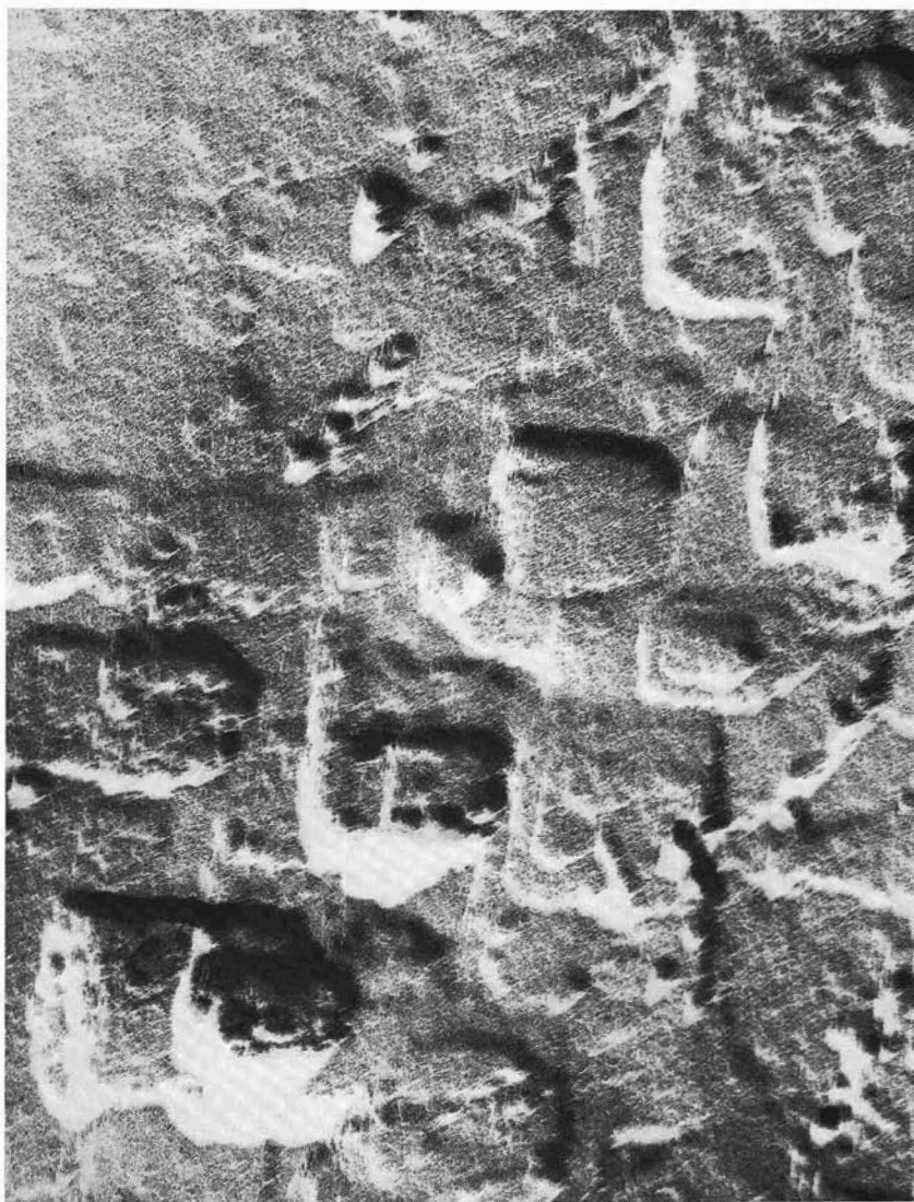
Fig. 24. — Fosse a contorno poligonale osservate in M.E.T. 29.250 \times .
