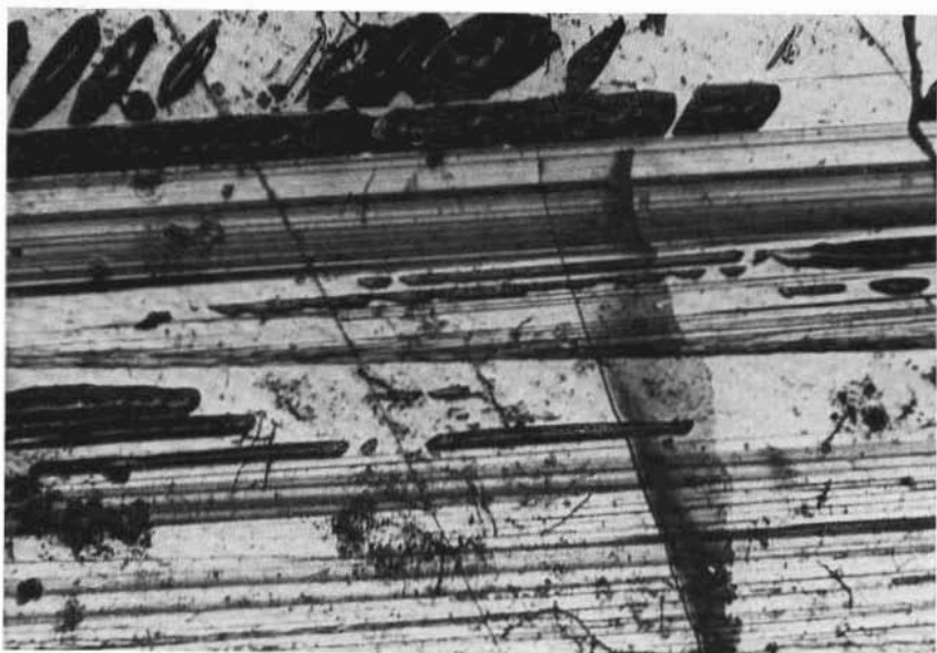
Fig. 18. — Cavità come in fig. 17. Si notino al bordo superiore i residui di una cavità preesistente separati da setti isorientati. Setti analoghi, in fase di più o meno avanzata formazione, si notano anche nelle altre cavità. 210 \times .
