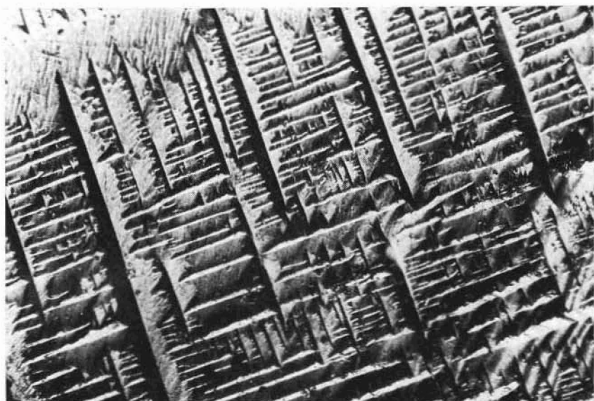
Fig. 9. — Formazione dendritica bidimensionale con rami principali e secondari. 120 \times .
