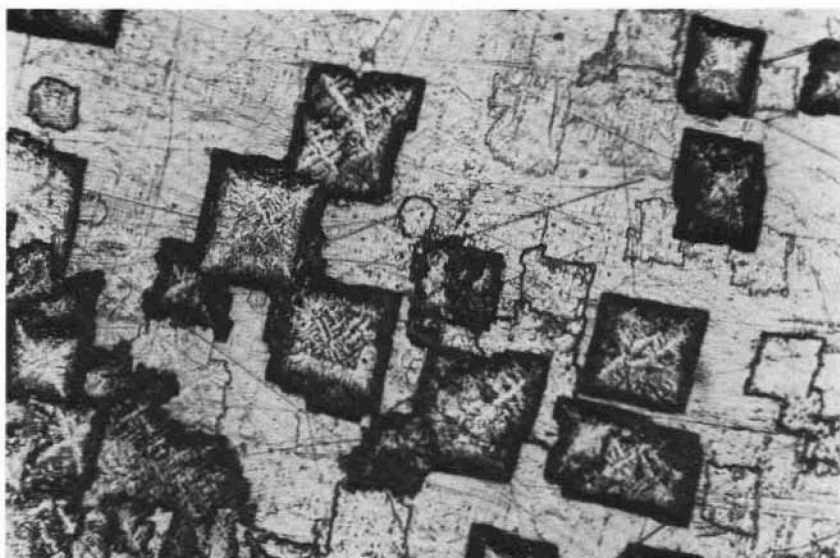
Fig. 11. — Dendriti in cavità a contorno quadrato. 210 X.
