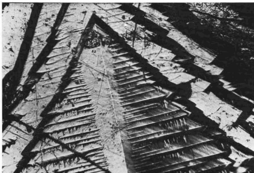
Fig. 10.— Formazione dendritica. E' visibile il ramo principale, con fenomeno di impingement . 210 \times .
