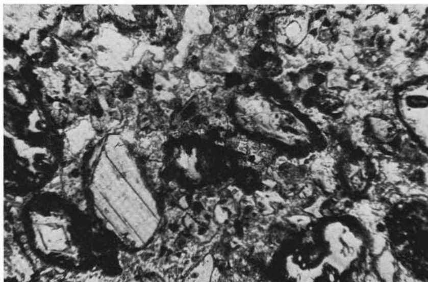
Fig. 23. — Ialoclastite trachibasaltica del vulcano di Solchiaro. Clasti di vetro, scorie devetrificate ai bordi e feno-cristallo di augite.
