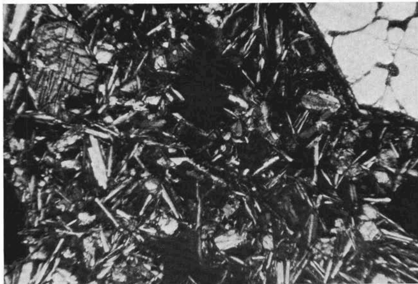
Fig. 17. — Blocco trachibasaltico olivinicco. Fenoeristallo di olivina (a destra) e augite (a sinistra) in massa di fondo a plagioclasio, augite, olivina. (nicols incr.; ingr. lin. 50)
