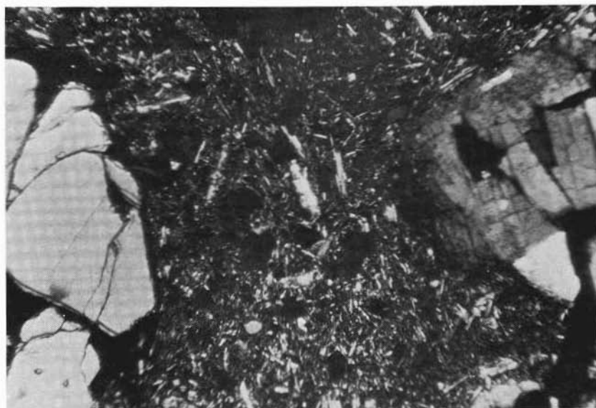
Fig. 18. — Blocco trachibasaltico olivinico (camp. PS 3 ). Fenocristalli di feldspato potassico (a destra) e olivina. (nicols incr.; ingr. lin. 50)
