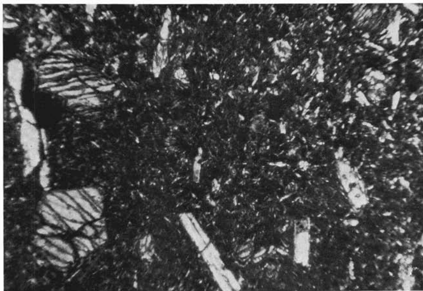
Fig. 19. — Blocco latitico. Fenocristalli di augite in massa di fondo feldspatica ipocristallina. (nicols incr.; ingr. lin. 50)
