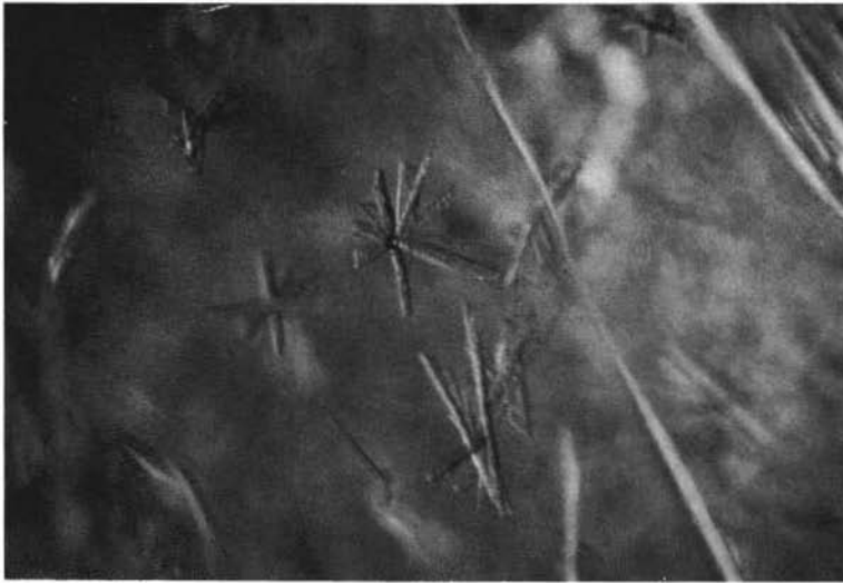
Fig. 7. — Verre vert . Cristoballite cristallisant autour de bulles d'air piégées formant germes.
