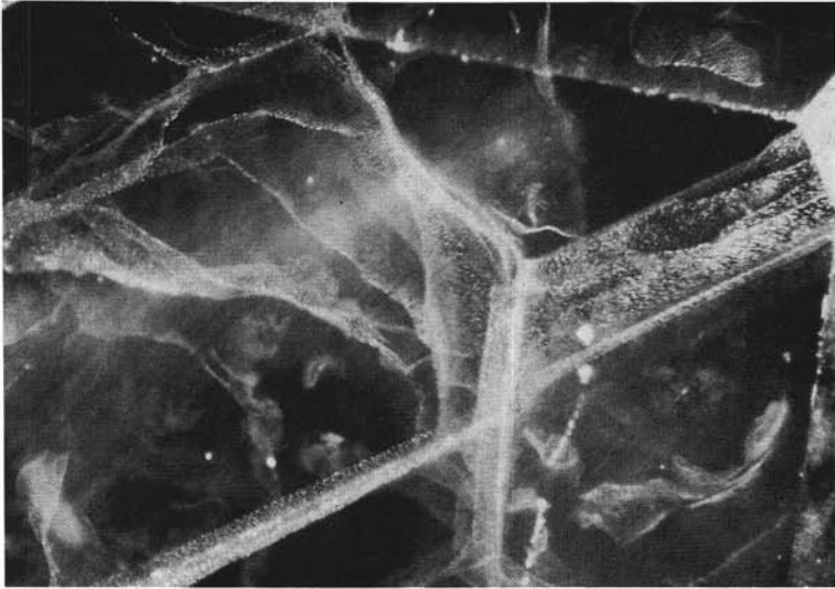
Fig. 5. — Émeraude Synthétique . Fabrication par dissolution dans un fondant: reliquats de fondant rassemblés dans des givres en forme de voile.
