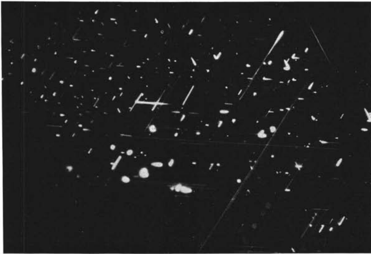
Fig. 1. — Rubis de Birmanie . Interférences sur des aiguilles de rutile ou de calcite.
