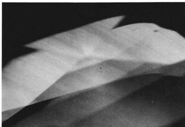
Fig. 4. — Saphir Synthétique . Fabrication par fusion dans la flamme: zones d'accroissement courbes.
