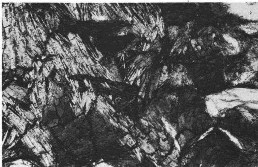
Fig. 3. — Fitto aggregato di lamelle di stilpnomelano disposte a ventaglio ed a covoni. Solo pol., 150 x.
