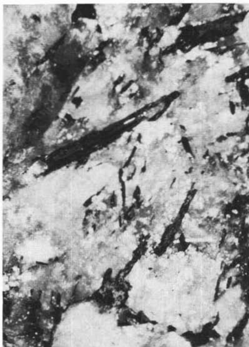
Fig. 3. — Cristalli di Boulangerite mostranti marcata anisotropia (a) e variamente orientati nel quarzo (b). N. + - (a) 100 x, (b) 200 x.
